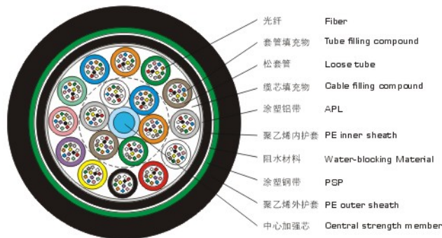
光缆结构图 Cable Structure
