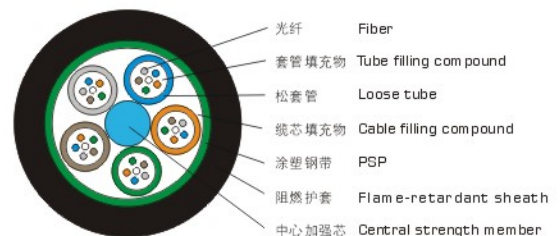
光缆结构图 Cable Structure
